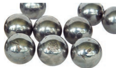
照片 4 ▪ 照片 2 的钢球 ▪ 钢球表面的剥落 ▪ 停机时冲击载荷造成的压痕发展而成
