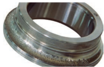
照片 1 ▪ 角接触球轴承的内圈 ▪ 滚道面半周产生剥落 ▪ 原因是由于切削液侵入造成的润滑不良
