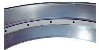
照片 8 ▪ 双列圆锥滚子轴承的外圈 ▪ 滚道面上产生了无数微小压痕 ▪ 由于异物侵入造成的
