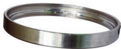
照片 3 ▪ 照片 2 的外圈 ▪ 滚道面上产生呈等球距分布的剥落 ▪ 停机时冲击载荷造成的压痕发展而成
