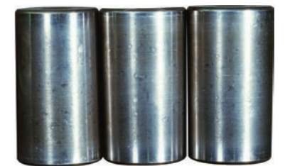
照片 6 ▪ 照片 5 的圆锥滚子 ▪ 整个滚动面上产生了无数大小不等的压痕 ▪ 由于异物侵入造成的
